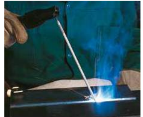
Elektrodenhandschweißen einer V-Naht
