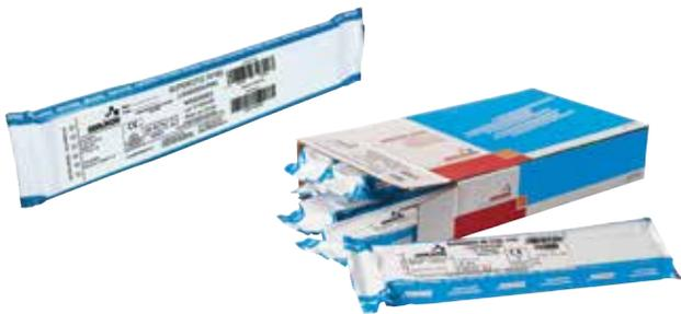
Elektroden in den wasserdampfdichten Verpackungen MEDIUM DRY und MICRO DRY bewahren ihren trockenen Herstellungszustand und müssen aus frisch geöffneten DRY-Verpackungen nicht zurückgetrocknet werden. Ebenso sind keine speziell trockenen Lagerbedingungen für die geschlossenen DRY Packs – z.B. auf Baustellen – erforderlich. MEDIUM DRY und MICRO DRY unterscheiden sich in der enthaltenen Elektrodenmenge und erlauben so die Anpassung an den Verbrauch des Schweißers.
