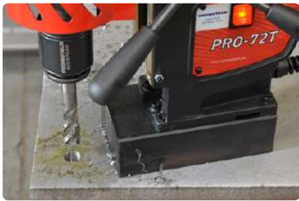
Gewindeschneiden von Durchgangsbohrungen bis M20
