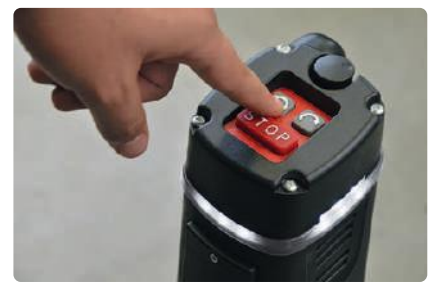
Linkslauf (linksdrehend). Benutzerfreundliche Steuerung der Gewindeschneidwerkzeugfreigabe
