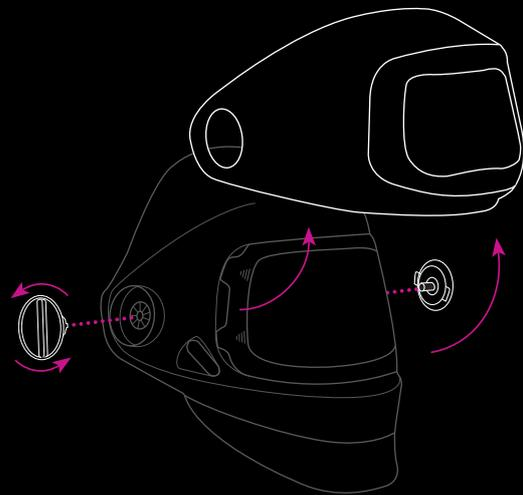
Für ausgedehntere Nicht-Schweißanwendungen können Sie das Schweißvisier von der Maske abnehmen, indem Sie die beiden Drehknöpfe lösen und danach wieder anbringen. Hierdurch reduzieren Sie das Maskengewicht um bis zu 36 %.
