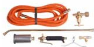
Bestehend aus: Propan-Handgriff, Verbindungsrohr 600 mm, Ablagevorrichtung, Kleindruckregler mit Kombianschluss und Manometer, 5 m HD-Schlauch (beidseitig 3/8“ LH Überwurfmutter), Schlauchbruchsicherung 12 kg/h
