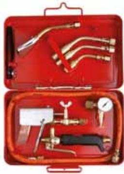
Bestehend aus: Propan-Handgriff, LötKolbenaufsatz mit 350 g HammlerlötKolben, Kleindruckregler „Mini“ mit Kombianschluss und Manometer, Hartlöteinsätze Gr. 12, 14, Weichlöteinsatz Gr. 5, Breitbrenneinsatz 64 mm, 1,5 m HD-Schlauch (beids. 3/8“ LH Überwurfmutter, Brennerschlüssel, Gasanzünder
