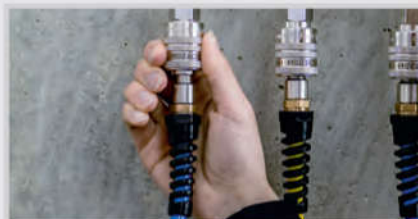
Entkuppeln - Stufe 1: Automatisches Entlüften
