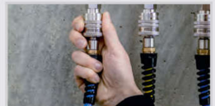
Entkuppeln - Stufe 2: gefahrloses Entkuppeln
