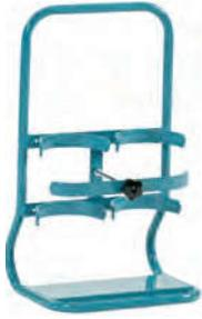
Standsichere Konstruktion mit großem Tragegriff. Zentraler Klemmbügel. Durch vier Bohrungen zur Aufnahme von eigenem Brennerkasten bis max. 320 mm Breite vorbereitet.
