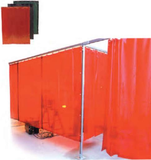
Die Schweißervorhänge sind rundum einreißfest gesäumt und zur Aufhängung an der Oberseite alle 20 cm mit verstärkten Ösen ausgerüstet. Seitlich sind zur Verbindung mehrerer Vorhänge alle 40 cm Druckknöpfe angebracht.
