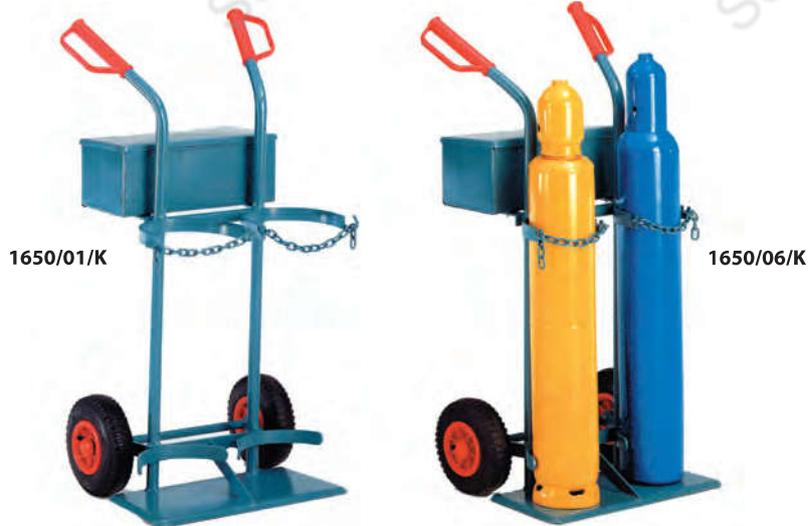
Dies sind die 2-Holm-Ausführungen der erfolgreichen 1-Holm-Wagen. Stahlkonstruktion aus 3/4"-Rohr. Standplatte, Kettensicherung, Handgriff mit Schutzbügel.
