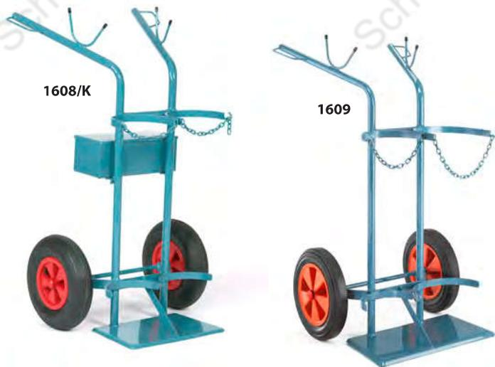
Robuste geschweißte Stahlrohrkonstruktion aus 1"-Rohr für 2 Stahlflaschen 40-50 Liter/ 210 Ø - 230 Ø. Serienmäßige Ausstattung: geschweißter Handschutzbügel aus 10-er Rundeisen; Schlauchhalterung auf den Holmen. Sicherungskette aus geraden Kettengliedern.
