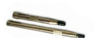
Anschleifhilfe mit Vorratsspeicher für bis zu 20 Elektroden, zum Anspitzen von kurzen Elektroden, inkl. 3 Stück Spannhülsen für Ø 1,6 + 2,4 und 3,2 mm, Gewicht: ca. 80-120g
