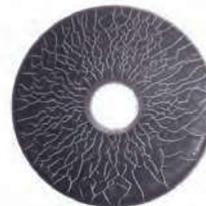
Mit Magnetpulver Suspension MPS-F (fluoreszierend) geprüft
