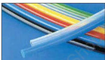
Schläuche aus Polyamid sind flexibel und lassen sich gut verlegen. Bevorzugt bei Druckluftbremsen, Pneumatik, Hydraulik, Kraftstoffleitungen nach DIN 73378, bzw. in schwarz LT DIN 74324 einsetzbar.
