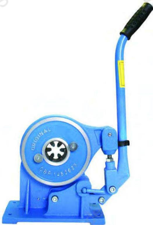
Die Niederdruckschlauchpresse bietet eine schnelle und sichere 6 Backen-Verpressung und ist speziell für Niederdruckschlauchhülsen mit einem Außendurchmesser von 11-30 mm entwickelt worden. Das Haupteinsatzgebiet ist die Armierung von Schlauchleitungen DN 3-16 (Gas, Öl, Luft, Wasser...)
