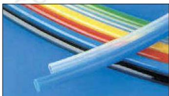
Schläuche aus PE finden Verwendung als Steuerleitung in der Regel- und Messtechnik, in der Labortechnik, im Apparate- und Behälterbau, in der Lebensmitteltechnik, etc. Geringes Gewicht, Schlagfestigkeit und weitgehende Beständigkeit gegen Säuren, Laugen und Salzlösungen sind charakteristische Eigenschaften.
