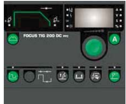
TIG DC Bedienfeld für Focus TIG 200 DC HP
