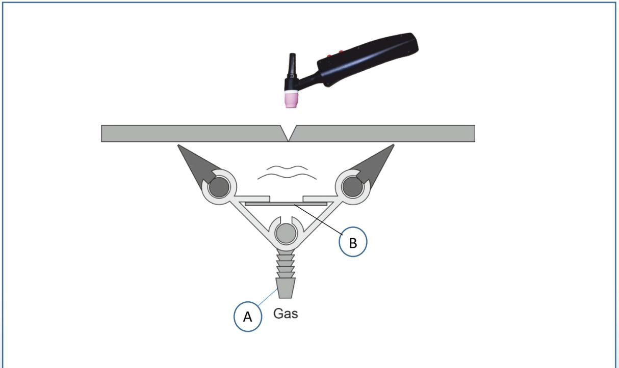
Reduziert den Gasverbrauch um 95% bei hervorragenden Schweißergebnissen.
