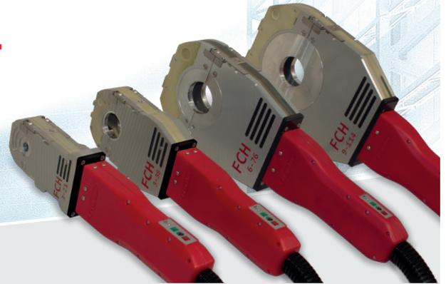
/ Geschlossene Schweißköpfe zum mechanisierten WIG Orbitalschweißen von dünnwandigen Rohrverbindungen (Außendurchmesser 3 - 114 mm, Wandstärken bis 3,5 mm) aus Edelstahl, Titan, Inconel, Aluminium und anderen Werkstoffen in der Mikroelektronik, Biochemie, Lebensmittelindustrie, Messtechnik, Luft- und Raumfahrt usw.
