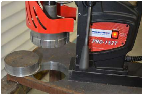
Fräseleistung bis zu 150 mm
