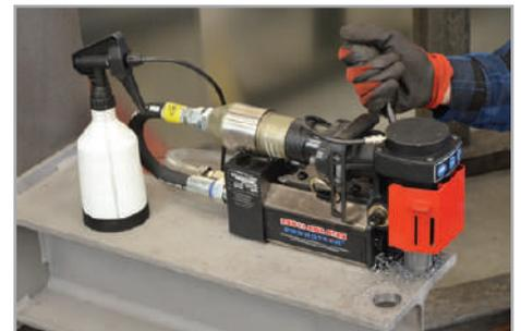
Kühlsystem durch die Spindel
