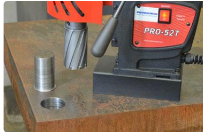
Fräisleistung bis zu 50 mm • Maximale Tiefe bis zu 75 mm
