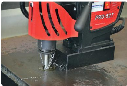
Durchgangsgewindebohren bis M20
