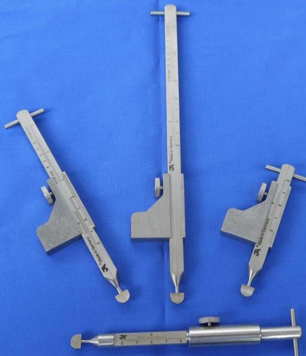
**Anwendung:** Zum Messen des Kantenversatzes zweier miteinander zu verschweißenden Gegenstände ab 3mm Luftspalt.
