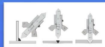
**90000118d** **Digitale** Schweißnahtlehre aus Edelstahl; zur Messung A -Mass u. Nahtüberhöhung und Kontrolle der V-Naht (für 60°/70°/80°/90°); Meßbereich 0-20 mm; Abmessung: 110 mm x 60 mm x 14 mm; 0,089 kg
