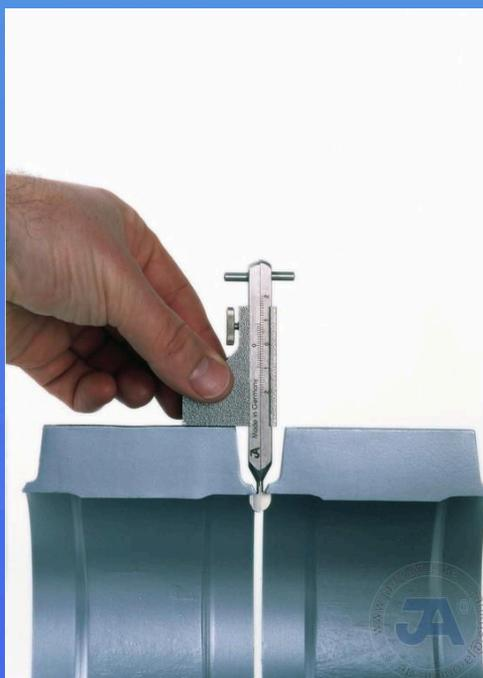
**9000A138** JA - Kantenversatzlehre aus Edelstahl, klein, mit Auflagefläche, Skala in Millimetern mit Nonius, Ablesegenauigkeit 1/10 mm, geeignet für Rohrschweißnähte bis 35 mm Wandstärke Messbereich: 20 mm; Länge: 105 mm; Gewicht: 0,155 kg
