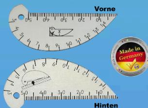
**90000118** Schweißnahtlehre komplett aus Edelstahl; zur Messung A -Mass u. Nahtüberhöhung und Kontrolle der V-Naht (für 60°/70°/80°/90°); Meßbereich 0-20 mm; Abmessung: 59 mm x 100 mm x 5,5 mm; 0,062 kg
