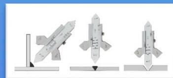
**90000118-JA** Schweißnahtlehre komplett aus Edelstahl; zur Messung A -Mass u. Nahtüberhöhung und Kontrolle der V-Naht (für 60°/70°/80°/90°); Meßbereich 0-20 mm; Abmessung: 59 mm x 100 mm x 8,0 mm; 0,106 kg
