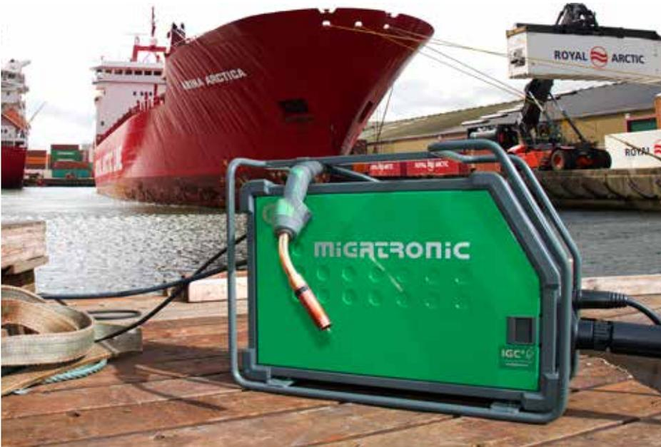
Omega Yard 300 ist die ideale Schweißmaschine für Werften und Werkstätten sowie für den Baustellen-einsatz; Abb. mit Schutzbügel (optionale Zusatzaus-rüstung).
