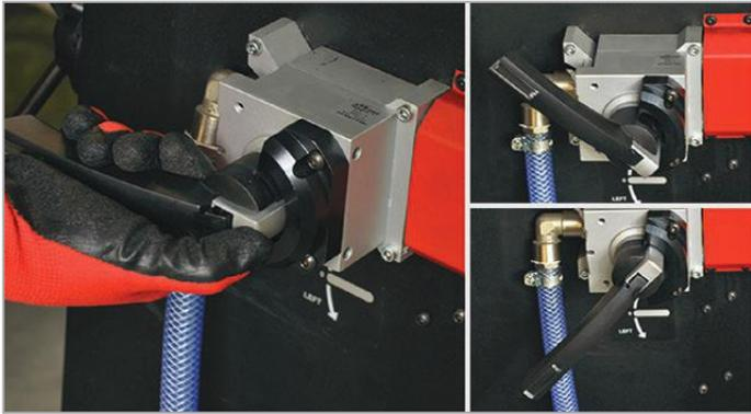
Es ist keine versehentliche Einschaltung des Motors möglich. Der Bediener muss gleichzeitig die Taste auf der Basis des Hebels drücken und den Ventilhebel bis zum Anschlag drehen, um den Motorstart zu ermöglichen
