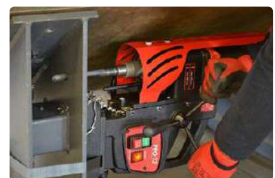
Bohrleistung bis zu 25 mm Geringes Gewicht von nur 18 kg
