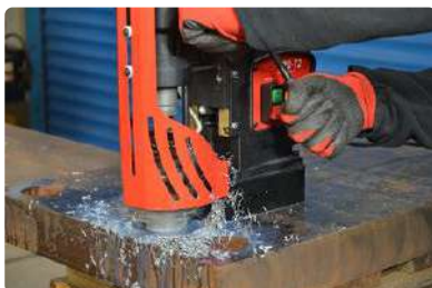
Fräseleistung bis zu 70 mm
