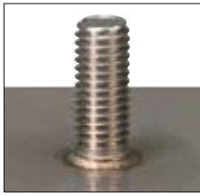
Kleiner, gleichmäßiger spritzerfreier Schweißwulst
