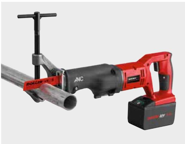
**Kraftvolle, robuste, kompakte Hybrid-Rohrsäge für Akku- und Netzbetrieb. Ideal für Stahlrohre und andere, sowie für viele Materialien, z. B. Holz, Holz mit Nägeln, Paletten, Metall, auch nichtrostenden Stahl, Guss, Porenbeton, Gipsplatten u. a. Li-Ion 22 V Technology! Akku Li-Ion 21,6 V, 9,0 Ah für ca. 80 Abschnitte Stahlrohr 1" mit Führungshalter mit einer Akkuladung.**
