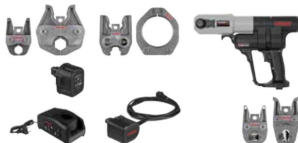
**Robuste, kompakte Hybrid-Radialpresse 32 kN, für Akku- und Netzbetrieb, mit automatischem Rücklauf (Zwangsablauf). Für Radial-Pressverbindungen Ø 10–108 (110) mm, Ø ¼–4". Akku Li-Ion 14,4 V, 3,0 Ah, für ca. 270 Pressungen mit einer Akkuladung.**
