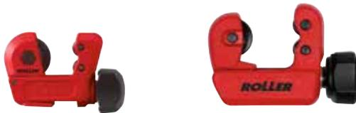
**Kleiner, handlicher Rohrabschneider für dünnwandige, nichtrostende Stahlrohre, Kupferrohre und andere, Ø 3–28 mm, Wanddicke s ≤ 4 mm.**
