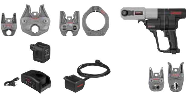
**Robuste, kompakte Hybrid-Radialpresse 32 kN, für Akku- und Netzbetrieb, mit Abschaltsignal. Für Radial-Pressverbindungen Ø 10–108 (110) mm, Ø ¼–4". Akku Li-Ion 14,4 V, 3,0 Ah, für ca. 270 Pressungen mit einer Akkuladung.**
