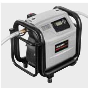
**Leistungsstarke, kompakte, elektronische Spüleinheit mit ölfreiem Verdichter. Zum Spülen mit Wasser oder Wasser/Luft-Gemisch, Desinfizieren, Reinigen, Konservieren von Rohrleitungssystemen. Spülen und Entschlammn von Rohren bis DN 50, Ø 2" mit einem Wasserdruck Rohrnetz bis 1 MPa/ 10 bar/145 psi. Wassertemperatur 5–35° C, Wasserdurchfluss bis 5 m³/h. Betrieb von Druckluftwerkzeugen mit Betriebsdruck bis 0,8 MPa/8 bar/116 psi, Saugleistung bis 230 NI/min.**
