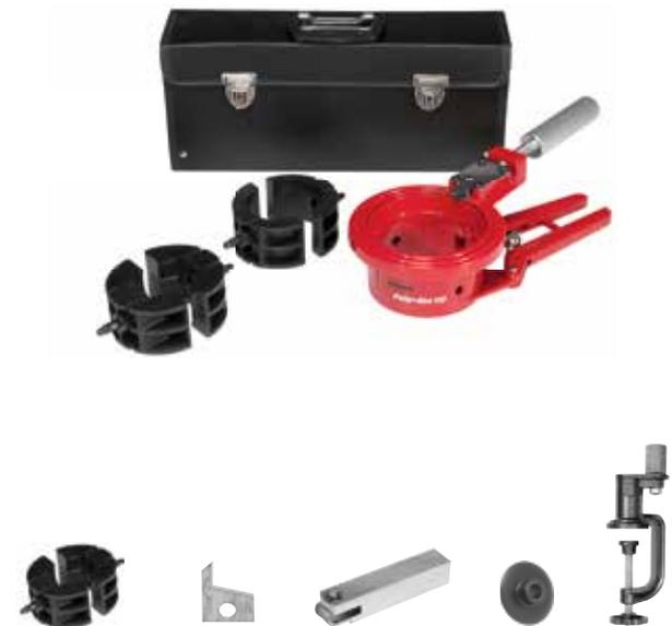
**Robustes Rohrtrenn- und Rohrfanfasgerät aus Metall zum rechtwinkligen, planen Trennen und Anfasen (15°) von Kunststoffrohren aus ABS, PB, PE, PE-HD, PE-X, PVC, PVDF, Ø 40–110 mm.**
