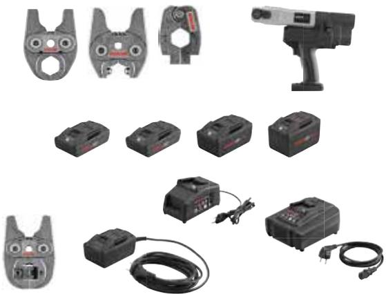
**Superhandliche, superleichte, robuste Hybrid-Radialpresse 22 kN, für Akku- und Netzbetrieb, mit automatischem Rücklauf (Zwangsablauf). Für Radial-Pressverbindungen Ø 10–40 mm, Ø ¼–1 ¼". Li-Ion 22 V Technology! Akku Li-Ion 21,6 V, 1,5 Ah, für ca. 250 Pressungen mit einer Akkuladung.**
