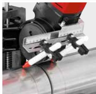
**Kompakte, leichte, robuste Rohrtrennmaschine zum Trennen und Entgraten von Rohren der Pressfitting-Systeme aus nichtrostendem Stahl, Kupfer, C-Stahl, Ø 8–108 mm, Stahlrohren EN 10255 (DIN 2440) DN 6–100, Ø ½–4", Ø 10–115 mm, Gussrohren (SML) EN 877 (DIN 19522) DN 50–100, Kunststoffrohren SDR 11 Wanddicke  $s \leq 10$  mm, Ø 10–110 mm, Ø ½–4", Verbundrohren Ø 10–110 mm.**
