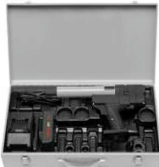
**Superhandliche, superleichte, robuste Hybrid-Axialpresse 20 kN bzw. 13 kN, für Akku- und Netzbetrieb, mit automatischem Rücklauf (ACC). Für Druckhülsenverbindungen Ø 12–40 mm. Li-Ion 22 V Technology! Akku Li-Ion 21,6 V, 1,5 Ah, für ca. 300 Pressungen mit einer Akkuladung.**
