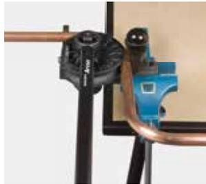
**Robuster Hand-Rohrbieger für harte, halbharte und weiche Kupferrohre (auch dünnwandig), Ø 10–22 mm, weiche ummantelte Kupferrohre (auch dünnwandig) Ø 10–18 mm, nichtrostende Stahlrohre der Pressfitting-Systeme Ø 12–18 mm, C-Stahlrohre der Pressfitting-Systeme Ø 12–22 mm (ummantelt bis Ø 18 mm), weiche Präzisionsstahlrohre Ø 10–20 mm, Elektroinstallationsrohre EN 50086 Ø 16–20 mm, Verbundrohre Ø 14–32 mm.**
