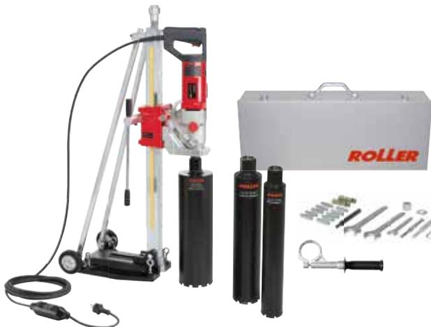
**Universelle, leistungsstarke, robuste, handliche Diamant-Kernbohrmaschine zum Kernbohren z. B. in Beton, Stahlbeton bis Ø 152 (200) mm, in Mauerwerk aller Art, Natursteine, Asphalt, Estrich aller Art, bis Ø 250 mm. Für Trocken- oder Nassbohrungen, handgeführt oder mit Bohrständern.**
