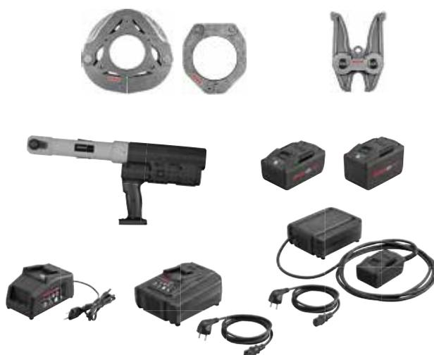
**Kraftvolle, universelle, robuste Hybrid-Radialpresse XL 45 kN, für Akku- und Netzbetrieb, mit automatischem Rücklauf (Zwangsablauf). Anti-Vibrations-System. Für Radial-Pressverbindungen XL Ø 64–108 mm, Ø 2½–4". Li-Ion 22 V Technology! Akku Li-Ion 21,6 V, 5,0 Ah, für ca. 150 Pressungen mit einer Akkuladung.**
