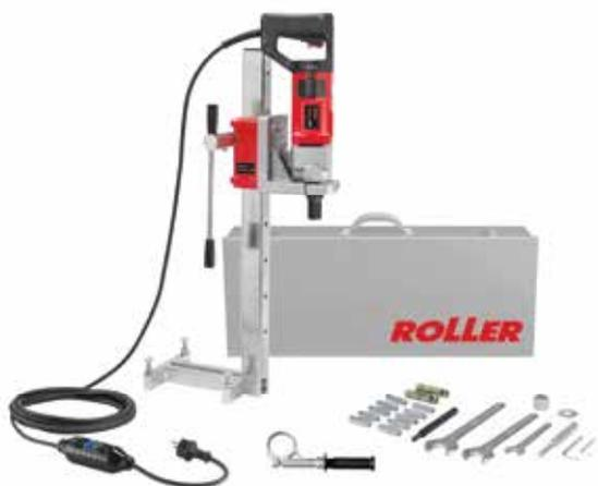
**Universelle, leistungsstarke, robuste, handliche Diamant-Kernbohrmaschine zum Kernbohren, z. B. in Beton, Stahlbeton bis Ø 102 (132) mm, in Mauerwerk aller Art, Natursteine, Asphalt, Estrich aller Art, bis Ø 162 mm. Für Trocken- oder Nassbohrungen, handgeführt oder mit Bohrständer.**
