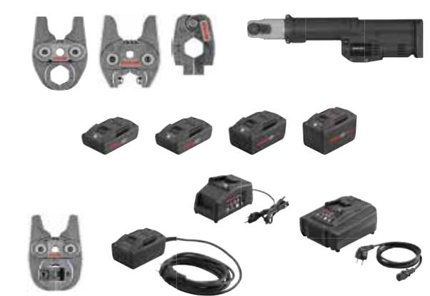
**Superhandliche, superleichte, robuste Hybrid-Radialpresse 22 kN, für Akku- und Netzbetrieb, mit automatischem Rücklauf (Zwangsablauf). Für Radial-Pressverbindungen Ø 10–40 mm, Ø ¼–1 ¼". Li-Ion 22 V Technology! Akku Li-Ion 21,6 V, 1,5 Ah, für ca. 250 Pressungen mit einer Akkuladung.**
