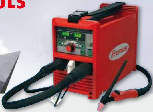
/ Die TransTig 1750 Puls ist klein, robust und vollkommen digitalisiert. Mit 9,1 kg ist die WIG-DC-Stromquelle ideal für den mobilen Einsatz unter harten Montagebedingungen oder auf Baustellen geeignet. Der Mikroprozessor steuert die Schweißstromquelle, das Ergebnis sind ein höchst stabiler Lichtbogen und 100 % reproduzierbare Schweißeigenschaften. Die Stromquelle ist für den Einsatz bis 170 A geeignet.
