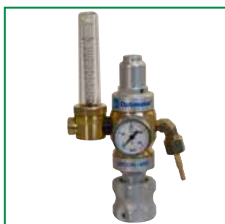
ARGON/MIX OPTIMATOR 1 DURCHFLUSSMESSER Argon/Misch Optimator mit eingebautem Gassparer. Bis zu 50% Gaseinsparung. Reduziert das Wechseln der Gasflaschen, was sich positiv auf Wirtschaftlichkeit und Effizienz auswirkt. Gasflaschengewinde: W21,8x14/1" Anschlussgewinde Maschine: G1/4" Artikel-Nr. ....81963047
