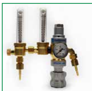
ARGON/MIX OPTIMATOR 2 DURCHFLUSSMESSER Argon/Misch Optimator mit 2 Durchflussmessern. Zum Gebrauch mit Schutzgas und Formiergas aus derselben Gasflasche. Mit eingebautem Gassparer. Bis zu 50% Gaseinsparung. Gasflaschengewinde: W21,8x14/1" Anschlussgewinde Maschine: G1/4" Artikel-Nr. ....81963050
