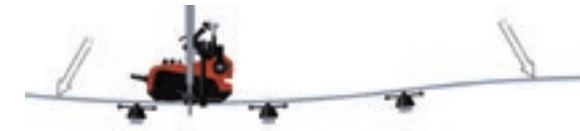
auf einer gewölbten Ebene mit Flex-Führungsschiene
