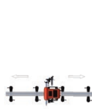
in horizontaler Position mit Führungsschiene (seitlich mit Magnethaltern)
