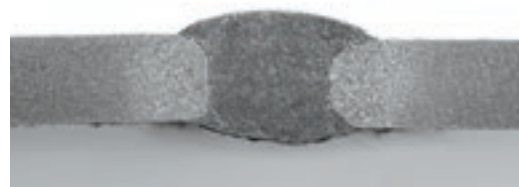
Optimales, leicht überwölbtes Nahtbild ohne Bindefehler – für ein Höchstmaß an Spalttoleranz und Spaltüberbrückung.
