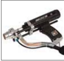
PH-2W mit verstärkter außenliegender Kabelführung
